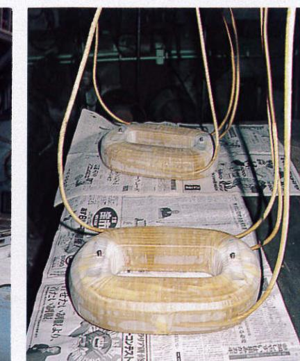
電磁攪拌コイル製作例
