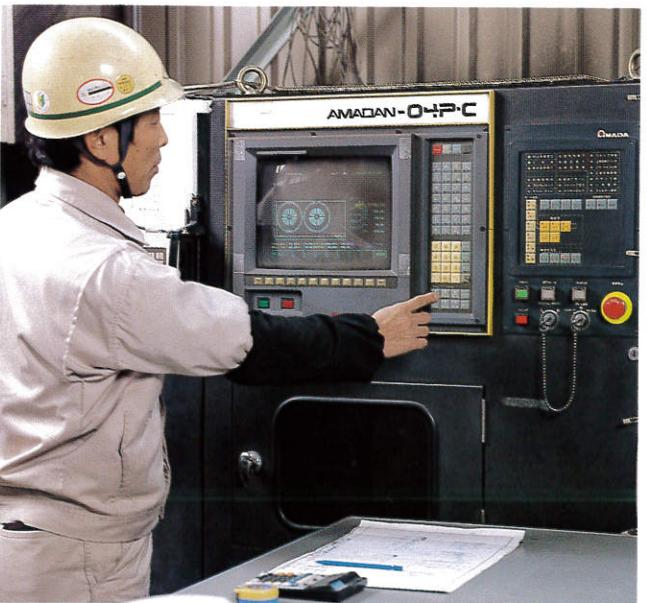
NCタレットパンチプレス入力作業風景（製缶工場にて）
