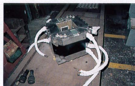
電磁攪拌機補修例
