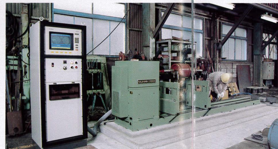
ダイナミックバランシングマシン（軸長3m／重量3tまで）
